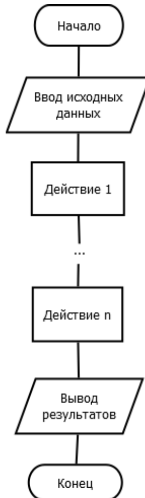
Рисунок 2 – Блок-схема линейного алгоритма
